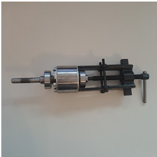
Die Kugellager werden mit dem Abzieher von der Welle gezogen.
