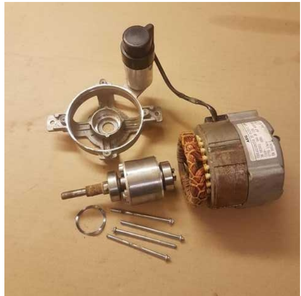
Der vollständig zerlegte Motor, bereit für den Lagertausch.
