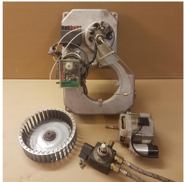
Der ausgebaute Motor, bereit für den Kugellagerwechsel.
