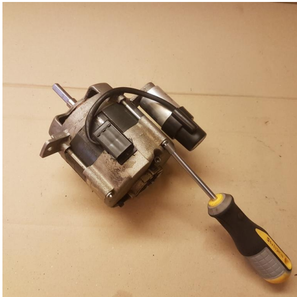
Der Ölbrennermotor wird für die Reparatur weiter zerlegt.
