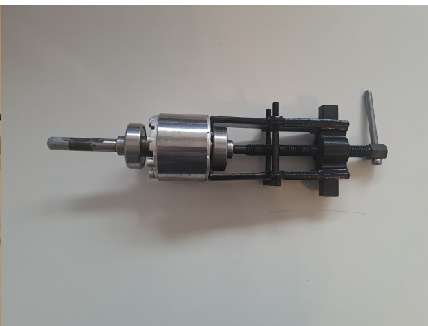
Die Kugellager werden getauscht.
