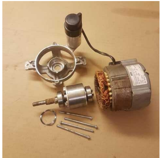
Der Motor zerlegt, bereit für den Lagertausch.
