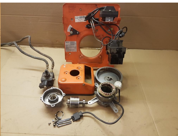
Der Ölbrenner nach dem Lagerwechsel.
