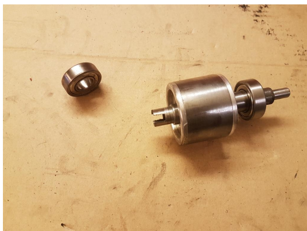
Die neuen Kugellager werden aufgesetzt.
