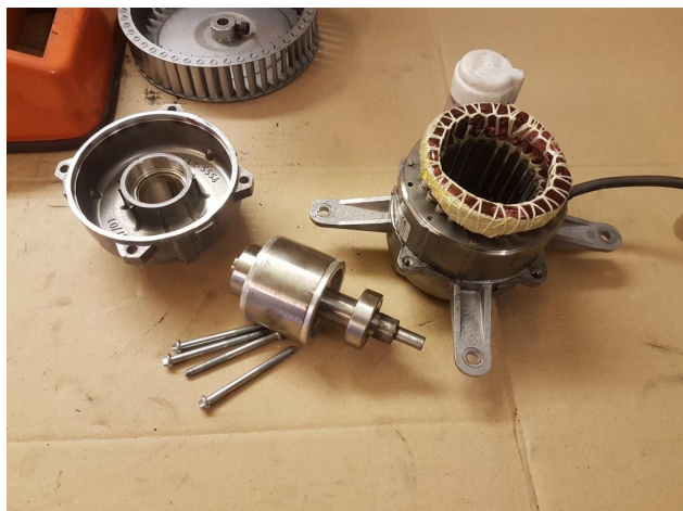
Der zerlegte Motor beim Kugellagerwechsel.
