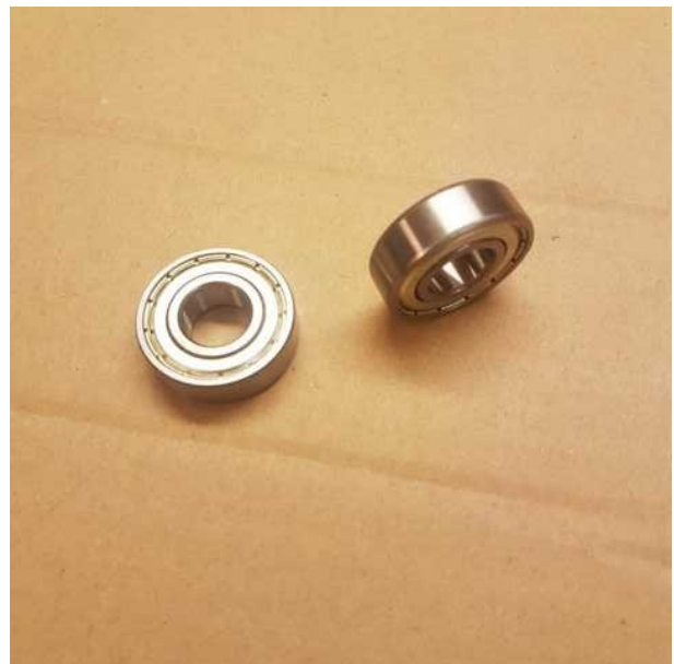
Neue Kugellager für den Öl- bzw. Gasbrenner.
