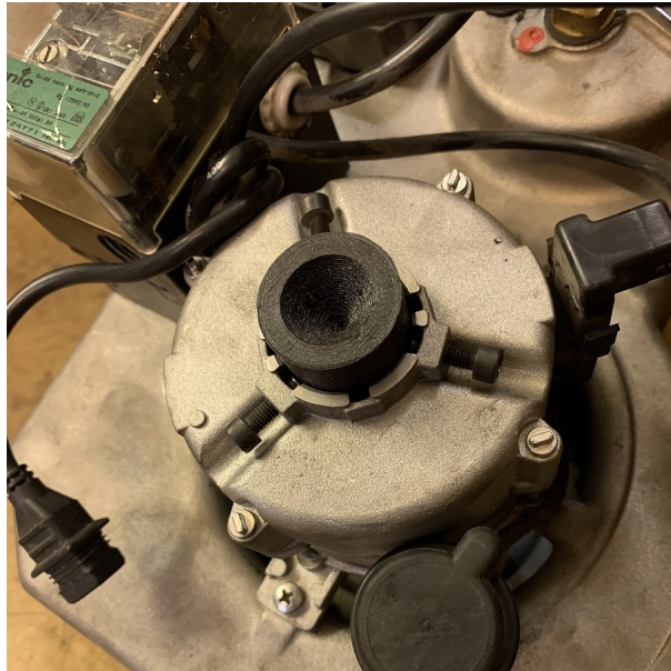
Die Motorwelle wird mit der Demontagehilfe blockiert (Beispielfoto an einem anderen Brennermodell).
