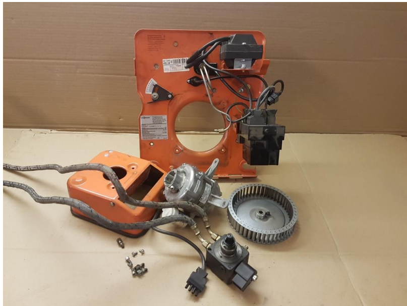
Der Ölbrenner komplett zerlegt.
